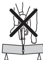
Si el disco se atasca o se engancha en el sector de riesgo de reculada, la fuerza reactiva empujará la cortadora hacia arriba y hacia atrás en dirección al usuario con un movimiento giratorio, lo que podría provocar daños graves o mortales. Preste atención al posible movimiento de la pieza de trabajo. Si la pieza de trabajo no está correctamente sujeta y se mueve durante el corte, se podría atascar el disco y provocar una violenta sacudida.
