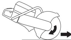
Não transporte a máquina com o equipamento de corte a rodar. A força giroscópica pode obstruir o movimento pretendido.
