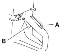
O bloqueio mantém-se apertado enquanto o acelerador estiver apertado. O acelerador e o bloqueio de acelerador retornam às suas posições originais quando se solta o punho. Isto ocorre por meio de dois sistemas de molas de retorno independentes entre si. Esta posição significa que o acelerador está sempre bloqueado na marcha em vazio.
