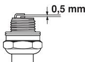
**ATENÇÃO!** Use sempre o tipo de vela de ignição recomendado! Uma vela de ignição incorrecta pode danificar o pistão/cilindro.
