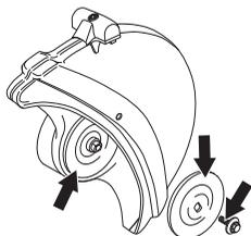
Não usar anilhas flangeadas empenadas, lascadas, contundidas ou sujas. Não usar anilhas flangeadas com dimensões diferentes.
