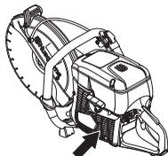
**ATENÇÃO!** Uma entrada de ar obstruída ou suja conduz a um sobreaquecimento da máquina, danificando o cilindro e o pistão.
