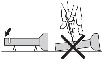
Caso se permita que o tubo afrouxe e feche o corte, a lâmina ficará presa no sector de risco de retrocesso, podendo provocar um retrocesso grave. Se o tubo estiver devidamente apoiado, a extremidade do tubo desloca-se para baixo, o corte abre e a lâmina não ficará presa.
