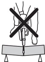
Caso a lâmina fique presa ou entalada na zona de retrocesso, a força reactiva faz com que a máquina seja arremessada para cima e para trás num movimento rotativo, podendo causar ferimentos graves e mesmo mortais. Tenha atenção à possibilidade de deslocação da peça em que está a trabalhar. Se a peça em que está a trabalhar não estiver devidamente apoiada e se deslocar durante o corte, poderá prender a lâmina e provocar um retrocesso.
