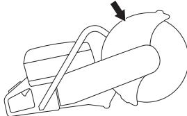
Проверка состояния режущего диска и его щитка.
