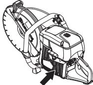
**NAPOMENA!** Prljav ili začepljen dovod vazduha dovodi do pregrevanja mašine, a samim tim do oštećenja klipa i cilindra.
