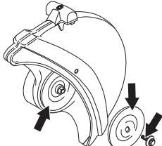
Ne koristite iskrivljene, iskrzane, udubljene niti prijave podloške obrubnice. Ne koristite podloške obrubnice različitih dimenzija.
