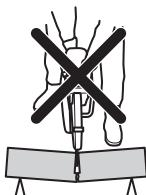
Ako se nož zaglavili ili zaustavi u zoni povratnog trzaja, motorni čistač će se usled reaktivne sile odbaciti i okrenuti unazad prema korisniku što dovodi do ozbiljnih ili čak fatalnih povreda. Pazite na moguće pokrete komada koji obrađujete. Ako komad koji obrađujete nije pravilno pričvršćen i pomeri se tokom sečenja, on može uštinuti sečivo i izazvati povratni trzaj.
