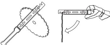
Ελέγχετε το εξάρτημα κοπής για ζημιές ή εμφάνιση ραγισμάτων. Το κατεστραμμένο εξάρτημα κοπής πρέπει πάντα να αντικαθίσταται.
