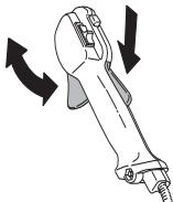
Δείτε τις οδηγίες του κεφαλαίου Εκκίνηση. Βάλτε σε λειτουργία το μηχάνημα και χρησιμοποιήστε πλήρες γκάζι. Αφήστε το γκάζι και ελέγχετε εάν το εξάρτημα κοπής σταματάει και παραμένει ακινητοποιημένο. Εάν το εξάρτημα κοπής περιστρέφεται με το γκάζι στη θέση ρελαντί, πρέπει να ελεγχθεί η ρύθμιση ρελαντί του καρμπυρατέρ. Δείτε τις οδηγίες του κεφαλαίου Συντήρηση.
