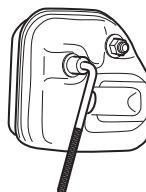
Εάν ο σιγαστήρας του μηχανήματος σας έχει και διχτυωτό φίλτρο σπινθήρων, θα πρέπει να το καθαρίζετε τακτικά. Ενα γεμάτο ακαθαρσίες φίλτρο
