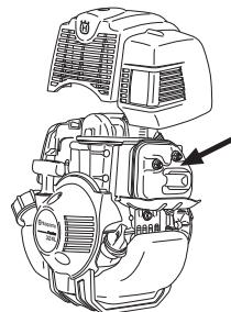
Ο σιγαστήρας του μηχανήματός σας έχει ένα τέτοιο δικτυωτό φίλτρο σπινθήρων, αυτό θα πρέπει να το καθαρίζετε τακτικά. Ενα βουλωμένο φίλτρο σπινθήρων προκαλεί υπερθέρμανση του κινητήρα, κάτι που μπορεί να καταλήξει σε σοβαρή βλάβη.
