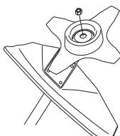
Κατά τη συναρμολόγηση, σφίξτε το παξιμάδι στρέφοντάς το αντίθετα προς τη φορά περιστροφής του εξαρτήματος κοπής. Χαλαρώστε το παξιμάδι για να το αφαιρέσετε, στρέφοντάς το κατά τη φορά περιστροφής του εξαρτήματος κοπής. (ΠΡΟΣΟΧΗ! το
