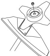
Ao montar, aperte a porca no sentido oposto ao sentido de rotação do equipamento de corte. Para desmontar, desaperte a porca no sentido da rotação do equipamento de corte. (NOTA! A porca tem rosca à esquerda.) Aperte a porca com a chave de caixa.
