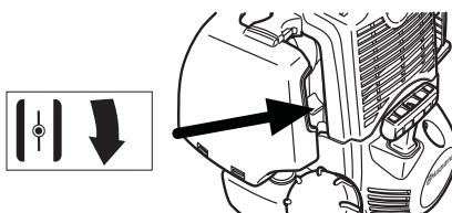
**Bomba de combustível:** Premir a bolha de borracha da bomba de combustível repetidas vezes, até que o combustível comece a encher a bolha. Não é necessário encher a bolha completamente.
