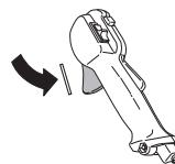
Apriete el fiador del acelerador y compruebe que vuelva a su posición de partida al soltarlo.
