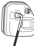
Se a sua máquina estiver equipada com um abafo-chamas, este deverá ser submetido a uma limpeza periódica. A rede obstruída leva a um aquecimento que pode acarretar sérios danos para o motor.
