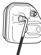
Si el silenciador de su máquina lleva rejilla apagachispas, límpiala a intervalos regulares. La obturación de la rejilla produce el sobrecalentamiento del motor, con el riesgo consiguiente de averías graves.
