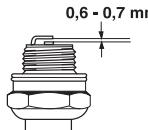
**NOTA!** Use sempre o tipo de vela de ignição recomendado! Uma vela de ignição incorrecta pode danificar o pistão/cilindro. Verifique se a vela de ignição não produz interferências de rádio.
