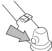
A massa lubrificante da caixa de engrenagens normalmente não necessita de ser substituída, a não ser no caso de eventuais reparações.
