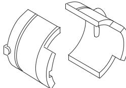
Compruebe regularmente que los elementos antivibraciones no estén agrietados o deformados.
