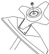
Para el montaje, apriete la tuerca girándola en sentido contrario al sentido de rotación del equipo de corte. Para el desmontaje, afloje la tuerca girándola en el sentido de rotación del equipo de corte. (NOTA: La tuerca tiene rosca a izquierdas.) Apriete la tuerca con la llave tubular.
