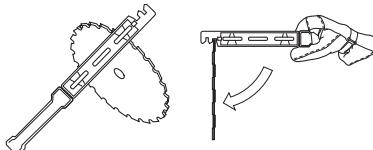
Revise el equipo de corte para ver si está dañado o agrietado. Un equipo de corte dañado debe ser siempre reemplazado.
