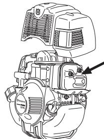
El silenciador de la máquina tiene un apagachispas que se debe limpiar regularmente. Un apagachispas obturado produce recalentamiento del motor, con el riesgo consiguiente de avería grave del motor.
