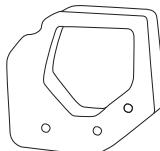
Un filtro utilizado durante mucho tiempo no puede limpiarse del todo. Por tanto, hay que cambiarlo a intervalos regulares. **Un filtro de aire averiado debe cambiarse.**
