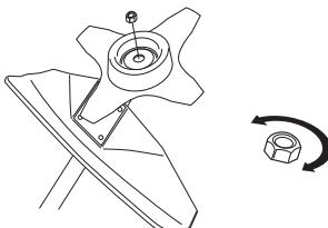
Ao afrouxar ou apertar a porca da lâmina de serra, há risco de ferimento causado pelos dentes da lâmina. Portanto, assegure-se de que a mão está protegida pela protecção da lâmina ao realizar esse tipo de trabalho. Use sempre uma chave de caixa com cabo suficientemente longo para possibilitar a operação. A seta na figura mostra dentro de qual área a chave de caixa deverá actuar para afrouxar e apertar a porca, respectivamente.
