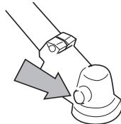
Generalmente, el lubricante en el cuerpo del engranaje no requiere cambiarse excepto cuando se realizan reparaciones.
