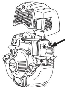
O silenciador da sua máquina está equipado com uma rede retentora de faíscas, que deve ser limpa regularmente. Uma rede obstruída pode levar a sobreaquecimento do motor e causar graves danos no mesmo.
