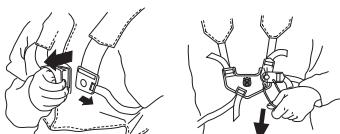
Verifique se as correias do suporte estão correctamente posicionadas. Quando o suporte e a máquina estão ajustados, verifique se o desengate de emergência do suporte funciona.
