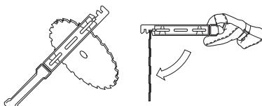
Verifique se o equipamento de corte está danificado ou com rachaduras. Um equipamento de corte danificado deve sempre ser substituído.
