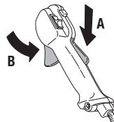
Verifique se o acelerador está fixo na posição marcha em vazio quando o bloqueio de acelerador estiver na sua posição original.
