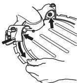
**¡NOTA!** La máquina debe estar en posición vertical. Si la máquina está colocada sobre un lado, el peso del disco dificulta la realización de un ajuste correcto. Un ajuste incorrecto puede causar daños en el disco. Si el disco gira despacio o se para, interrumpa el corte de inmediato y localice la avería.
