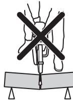
Pokud dojde k zaseknutí kotouče v zóně zpětného rázu, reaktivní síla rozbrušovací pilu vymrštit směrem nahoru a zpět k uživateli rotačním pohybem způsobujícím vážné nebo dokonce smrtelné zranění. Mějte se na pozoru před možným pohybem zpracovávaného dílu. Pokud není zpracovávaný díl řádně podepřen a při řezání se posouvá, může přiskřípnout kotouč a způsobit zpětný ráz.
