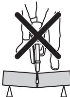
Ak sa kotúč zasekol alebo uviazol v zóne spätného nárazu, reakčná sila rotačným pohybom vyhodí rozbrusovaciu pílu dozadu smerom na používateľa a môže spôsobiť vážne alebo dokonca smrteľné zranenie. Dávajte pozor na potenciálny pohyb obrobku. Ak obrobok nie je pevne podporený a pri rezaní sa posunie, mohol by zovrieť kotúč a spôsobiť spätý náraz.
