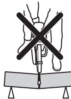
Jeżeli tarcza zaciśnie się lub zaklinuje w strefie odbicia, siła reakcji pchnie przecinarkę do góry i do tyłu w stronę użytkownika w ruchu obrotowym, powodując poważne lub nawet śmiertelne obrażenia. Uważnie obserwuj potencjalne ruchy ciętego materiału. Jeśli materiał cięty nie został prawidłowo podparty i przesuwa się podczas cięcia, może nastąpić zaciśnięcie tarczy i odbicie.
