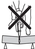
Ha a korong a visszarúgási zónában csípődik be vagy akad el, a gép a reakcióerő hatására forgó mozgással felfelé és hátra dobódik, a felhasználó felé, és így súlyos, akár halálos sérülést is okozhat. Legyen elővigyázatos, ha a munkadarab megmozdul. Ha a munkadarab nincs megfelelően megtámasztva, és vágás közben eltolódik, becsípheti a pengét, ami visszarúgást okozhat.
