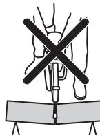
Jeżeli tarcza zaciśnie się lub zaklinuje w strefie odbicia, sila reakcji pchnie przecinarkę do góry i do tyłu w stronę użytkownika w ruchu obrotowym, powodując poważne lub nawet śmiertelne obrażenia. Uważnie obserwuj potencjalne ruchy ciętego materiału. Jeżeli materiał cięty nie został prawidłowo podparty i przesuwa się podczas cięcia, może nastąpić zaciśnięcie tarczy i odbicie.
