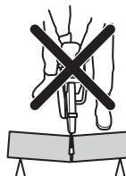
Pokud dojde k zaseknutí kotouče v zóně zpětného rázu, reaktivní síla rozbrušovací pilu vymrští směrem nahoru a zpět k uživateli rotačním pohybem způsobujícím vážné nebo dokonce smrtelné zranění. Mějte se na pozoru před možným pohybem zpracovávaného dílu. Pokud není zpracovávaný díl řádně podepřen a při řezání se posouvá, může přiskřípnout kotouč a způsobit zpětný ráz.
