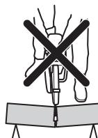
Ak sa kotúč zasekol alebo uviazol v zóne spätného nárazu, reakčná sila rotačným pohybom vyhodí rozbrusovaciu pílu dozadu smerom na používateľa a môže spôsobiť vážne alebo dokonca smrteľné zranenie. Dávajte pozor na potenciálny pohyb obrobku. Ak obrobok nie je pevne podopretý a pri rezaní sa posunie, mohol by zovrétť kotúč a spôsobiť spätný náraz.
