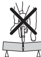
Ha a korong a visszarúgási zónában csípődik be vagy akad el, a gép a reakcióerő hatására forgó mozgással felfelé és hátra dobódik, a felhasználó felé, és így súlyos, akár halálos sérülést is okozhat. Legyen elővigyázatos, ha a munkadarab megtámasztva, és vágás közben eltolódik, becsípheti a pengét, ami visszarúgást okozhat.
