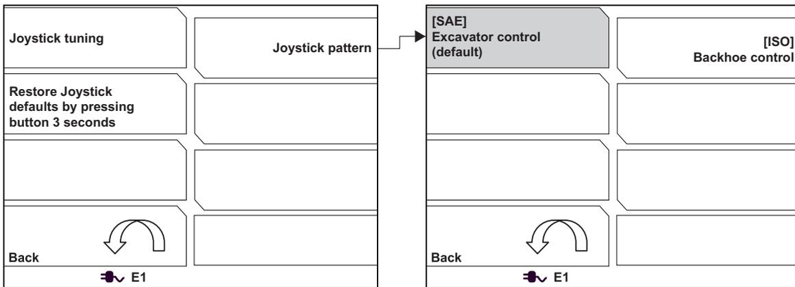
Выбор схемы работы джойстика изменяет настройки работы дистанционного управления. Схема работы изменяется, как указано ниже, при выборе управления задней лопатой [ISO].
