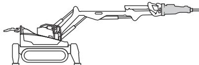
На машину устанавливают навесное оборудование, которое предназначено для выполнения тех или иных задач. Вес и эксплуатационные параметры навесного оборудования являются решающим фактором для принятия решения о пригодности оборудования для машины. Более подробную информацию см. в главах "Навесное оборудование" и "Технические данные" инструкций изготовителя.
