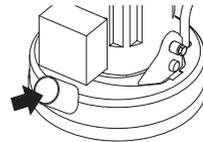
真空クリーナーのフィルターが損傷せず、汚れてないことを確認してください。動作時は、粉塵に注意してください。
