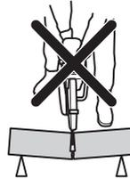
如果锯片被夹在或停在反弹区，反作用力会将切割锯向上向后抛起并旋转飞向使用者，造成严重的甚至致命性伤害。要警惕工件可能的移动。如果工件未妥善支撑并在切割时发生移位，可能会夹住锯片，导致反弹。
