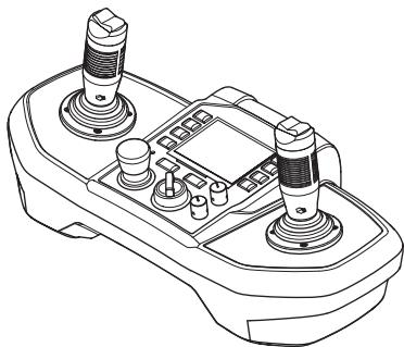
机器由遥控装置进行控制。信号既可以通过无线（蓝牙）传输，也可以通过电缆传输。
