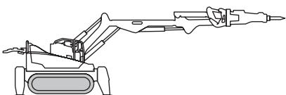
履带由液压马达单独驱动。用不同速度操作履带就会使机器转向。沿不同方向操作履带可实现机器在狭窄空间内的机动性操纵。在驱动功能未启用的情况下，被动制动会锁定驱动马达。
