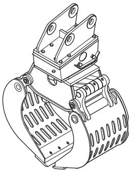
抓爪用于拆除木结构和砖墙，以及用于分拣和装载作业。它不适用于拉/拆横梁、拉条和墙壁。它也不适用于锤打/劈砍、移动和转运物体。
