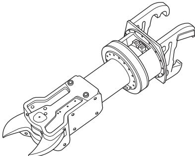
钢剪可通过其钳口切断金属材料。不可用于拉动和撬动松动的材料。
