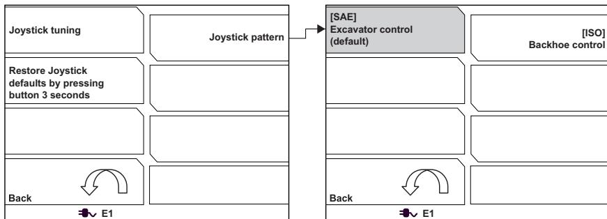
操纵杆的模式改变遥控装置的操作。当选择[ISO]反铲控制装置后，操作模式按照如下变化。
