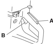
Blokada wyłącznika pozostaje wcisnięta dopóty, dopóki wcisnięty jest wyłącznik. Z chwilą puszczenia uchwytu zarówno dźwignia gazu, jak i przycisk blokady powraca do swojego pierwotnego położenia. Odbywa się to za pomocą dwóch niezależnie od siebie działających sprężyn powrotnych. Oznacza to, że dźwignia gazu zostaje automatycznie zabezpieczona w położeniu biegu jałowego.
