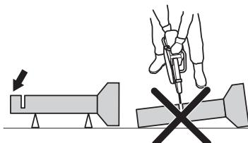
Pokud se trubka může prohnout a uzavřít řez, dojde k sevření kotouče v zóně zpětného rázu, což může vyvolat silný zpětný ráz. Pokud je trubka řádně podepřena a konec trubky se pohně směrem dolů, řez se otevře a nedojde k přiskřipnutí.
