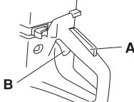
Poistka páčky zostane stlačená, pokiaľ bude stlačený plyn. Keď povolíte stisk držadla, páčka plynu aj poistka páčky plynu sa vrátia do svojej pôvodnej polohy. Je to riadené dvomi nezávislými vrátnymi pružinovými systémami. To znamená, že páčka plynu sa automaticky zablokuje v polohe voľnobehu.
