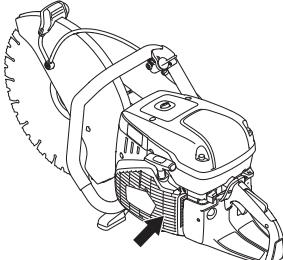
**FONTOS!** Szennyezett vagy eltömödött levegőbeömlő nyílásnak a gép túlmelegedése az eredménye, ami a dugattyú és a henger károsodását okozza.
