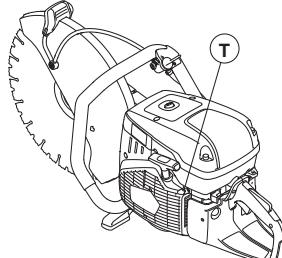
Zalecana prędkość obrotowa na biegu jałowym: 2700 obr/min
