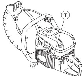
Odporučané otáčky pri vol'nobehu: 2700 rpm
