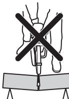
Pokud dojde k zaseknutí kotouče v zóně zpětného rázu, reaktivní síla rozbrušovací pilu vymrští směrem nahoru a zpět k uživateli rotačním pohybem způsobujícím vážné nebo dokonce smrtelné zranění. Mějte se na pozoru před možným pohybem zpracovávaného dílu. Pokud není zpracovávaný díl řádně podepřen a při řezání se posouvá, může přiskřipnout kotouč a způsobit zpětný ráz.
