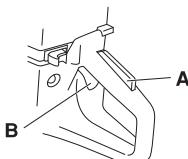
A gázsabályozó zárja mindenkorben benyomott helyzetben marad, amíg a gázsabályozó meg van nyomva. Amikor elengedjük a markolatot, mindenkorben a gázsabályozó, mindenkorben a gázsabályozó zár visszaáll eredeti kiindulóhelyzetébe. Mindez mindenkorben a független rugórendszeren keresztül történik. Ez a helyzet mindenkorben takarja, hogy a gázsabályozó automatikusan üresjáratba záródik.
