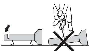
W przypadku zapadnięcia rury i zamknięcia cięcia może nastąpić zaciśnięcie tarczy w strefie odbicia i bardzo poważne odbicie. Końcówka prawidłowo unieruchomionej rury opuszcza się, następuje otwarcie obszaru cięcia i nie następuje zaciśnięcie.
