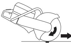
Nikdy nepohybujte strojom, keď sa rezné zariadenie otáča. Gyroscopicke sily môžu zabrániť zamýšľanému pohybu.
