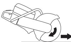
Ne helyezze át a gépet mozgásban lévő vágószerkezettel. A giroszkopikus erő akadályozhatja a kívánt mozgást.
