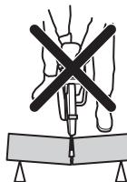
Ak sa kotúč zasekol alebo uviazol v zóne spätného nárazu, reakčná sila rotačným pohybom vyhodí rozbrusovaciu pílu dozadu smerom na používateľa a môže spôsobiť vážne alebo dokonca smrteľné zranenie. Dávajte pozor na potenciálny pohyb obrobku. Ak obrobok nie je pevne podopretý a pri rezaní sa posunie, mohol by zovrťť kotúč a spôsobiť spätný náraz.
