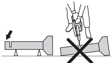
Ak umožníte potrubiu, aby kleslo a uzavrelo rez, zovrie kotúč v zóne spätného nárazu a môže sa vyvinúť prudký spätný náraz. Ak je potrubie riadne podložené, koniec potrubia bude klesať, rez sa bude otvárať a nedôjde k zovretiu kotúča.
