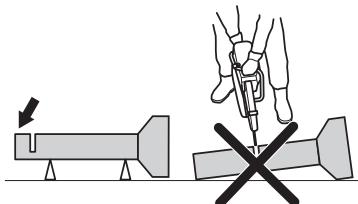
Ha a cső elhajlik és a vágás összezárodik, a penge becsípődhet a visszarágási zónában, és súlyos visszarágás keletkezhet. Ha a cső megfelelően van alátámasztva, a cső vége lefelé mozdul el, a vágás szétnyílik, és nem történik becsípődés.
