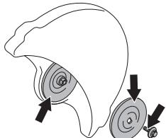
Nepoužívejte nikdy křivé, uražené, naražené nebo znečištěné podložky příruby. Nepoužívejte podložky příruby různých rozměrů.
