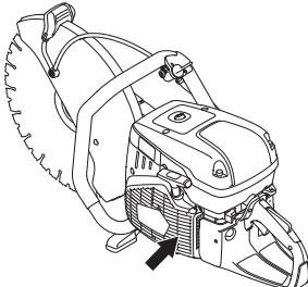
**UPOZORNĚNÍ!** Znečištěný nebo ucpaný přívod vzduchu má za následek přehřívání zařízení, což vede k poškození válce a pístu.
