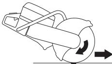
Se strojem nikdy nepohybujte, je-li řezné zařízení v pohybu. Zamýšlenému pohybu mohou bránit gyrokopické síly.
