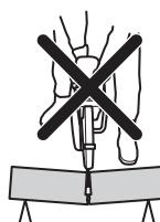
Ha a korong a visszarúgási zónában csípődik be vagy akad el, a gép a reakcióerő hatására forgó mozgással felfelé és hátra dobódik, a felhasználó felé, és így súlyos, akár halálos sérülést is okozhat. Legyen elővigyázatos, ha a munkadarab meghozzájárul. Ha a munkadarab nincs megfelelően megtámasztva, és vágás közben eltolódik, becsípheti a pengét, ami visszarúgást okozhat.
