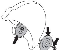
Nepoužívajte prírubové podložky, ktoré sú pokrivené, majú poškodené okraje, vyzkazujú známky poškodenia nárazom alebo sú znečistené. Nepoužívajte rôzne veľkosti prírubových podložiek.
