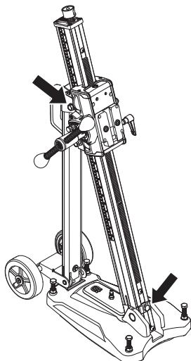
Uvoľnite poistné skrutky pre naklonenie stípika a nastavte požadovaný uhol. Uvoľnite poistné skrutky. Použite vodiacu rukováť. Stípik je možné naklňať do uha 0 – 60°.
