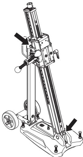
Povolte pojistné šrouby pro sklon sloupku a nastavte požadovaný úhel vrtání. Utáhněte pojistné šrouby. Použijte oboustrannou páku posuvu. Sloupek lze naklonit v úhlu 0–60 °.
