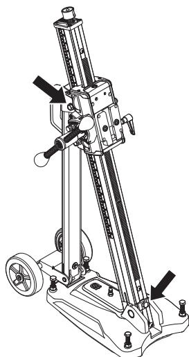
Połuzować śruby blokujące pochylenia kolumny i ustawić odpowiedni kąt. Dokręcić śruby blokujące. Użyć korby posuwu. Kolumnę można pochylać w zakresie 0–60°.
