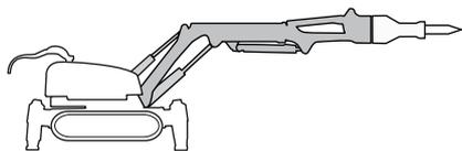
Das Armsystem besteht aus drei Komponenten, um höchstmögliche Beweglichkeit, große Reichweite und Kompaktheit zu gewährleisten. Erweiterbare Wellen minimieren das Risiko von Spielraum innerhalb der Verbindungsstellen.
