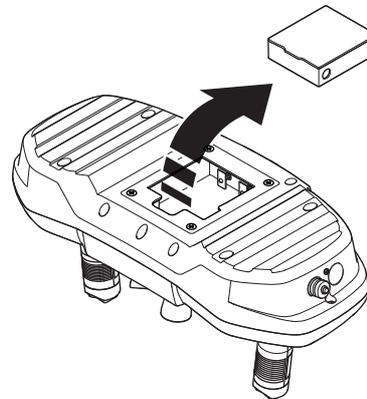
Bevor Sie die Fernsteuerung zum ersten Mal in Betrieb nehmen, muss der Akku aufgeladen werden.
