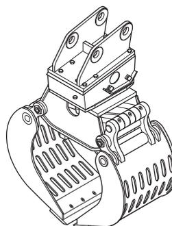
Die Greifer sind für den Abbruch von Holzbauten und Ziegelwänden sowie Sortier- und Verladearbeiten vorgesehen. Sie sind nicht für das Ziehen oder den Abbruch von Balken, Streben und Wänden vorgesehen. Genauso wenig sind sie für das Schlagen/Hacken oder den Transport von Lasten vorgesehen.
