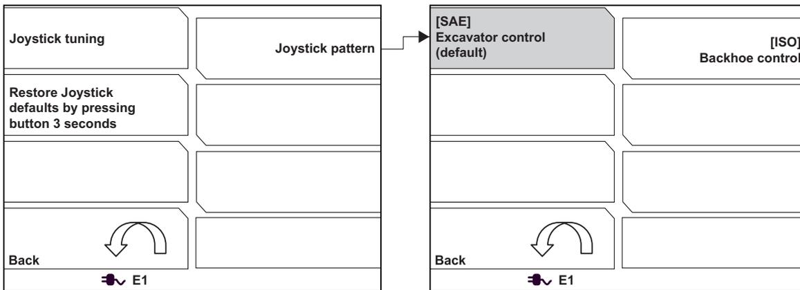
Das Joystick-Muster ändert die Bedienung der Fernbedienung. Das Betriebsmuster ändert sich wie unten, wenn die [ISO] Baggersteuerung ausgewählt ist.
