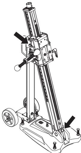
Draai de borgschroeven voor de kolomschuinstelling los en stel de gewenste boorhoek in. Draai de borgschroeven vast. Gebruik de toeverhandgreep. De kolom kan in een hoek van 0-60° worden gezet.
