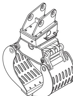
Les pinces sont conçues pour démolir des structures en bois et des murs en brique, ainsi que pour le tri et le chargement. Elles ne sont pas destinées à tirer/démolir des poutres, des entretoises et des murs. Elles ne sont pas non plus destinées aux opérations de frappe/tronçonnage et de transport de charges.
