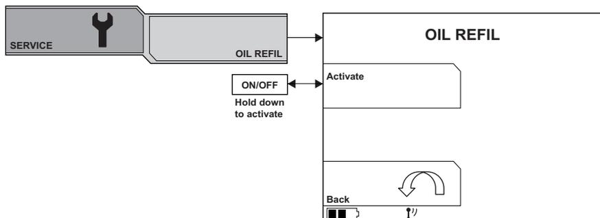
Le niveau d'huile se lit via la jauge visuelle sur le réservoir hydraulique. Faites l'appoint d'huile si le niveau se situe à plus de 1 cm en dessous du repère maximum lorsque tous les cylindres sont rétractés.
