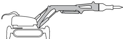
Le système de bras est divisé en trois parties afin de fournir un mouvement large, une portée longue et une compacité. Étirer les arbres minimise le risque de jeu au niveau des joints.
