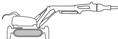
Les chenilles fonctionnent de manière isolée avec des moteurs hydrauliques séparés. Il est possible de faire tourner la machine en faisant fonctionner les chenilles à des vitesses différentes. L'utilisation des rails dans des directions différentes permet à la machine d'effectuer des manœuvres précises. Lorsque la fonction de commande n'est pas activée, les freins passifs bloquent les moteurs de commande.
