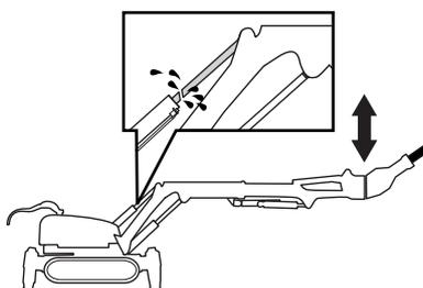
Le cylindre 3 est en position extérieure et le marteau travaille vers le bas. Ne mettez jamais les cylindres en position finale.
