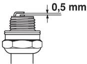
**DĖMESIO!** Visada naudokite rekomenduojamo tipo uždegimo žvakes! Naudojant netinkamą uždegimo žvakę, galite sugadinti stūmoklį ir cilindrą.
