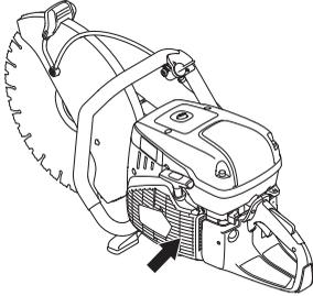
**DĖMESIO!** Jei įrenginio oro įsiurbimo sistema užteršta ar užsikimšusi, įrenginys perkais ir dėl to sugadinsite stūmoklį ir cilindrą.
