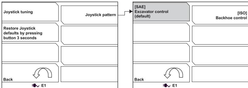
Выбор схемы работы джойстика изменяет настройки работы дистанционного управления. Схема работы изменяется, как указано ниже, при выборе управления задней лопатой [ISO].
