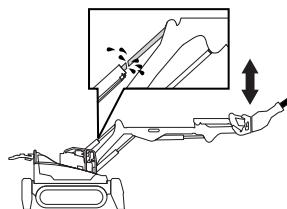
Цилиндр 3 выдвинут, молот работает вниз. Нельзя допускать работу машины, если цилиндры находятся в крайних положениях.
