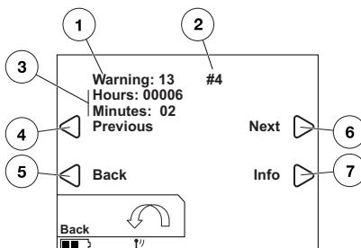
1 Код предупреждения: Определяет тип зарегистрированного предупреждения.
