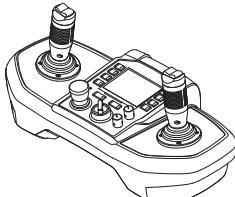
Машина управляется с пульта дистанционного управления. Сигналы поступают либо по беспроводной системе Bluetooth, либо по кабелю. Перемещение рычага управления имеет пропорциональный характер. Небольшое перемещение означает, что механизм будет перемещаться медленно, а большее перемещение вызовет перемещение механизма с большей скоростью.
