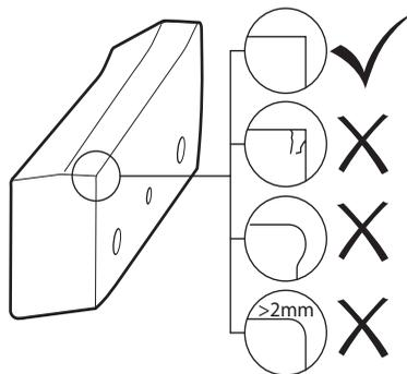
**UWAGA!** Uszkodzone nożyce mogą spowodować uszkodzenie narzędzia. Nigdy nie używać przecinarke, która jest popękana lub uszkodzona.
