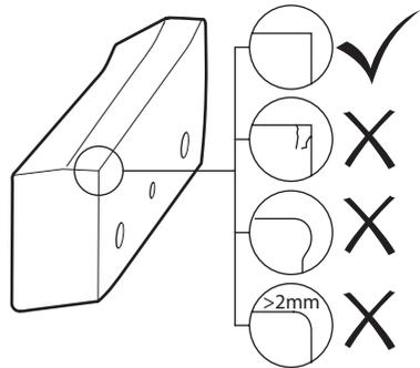
**注意！** 剪切机损坏可能会导致工具损坏。切勿使用开裂或损坏的切割锯。
