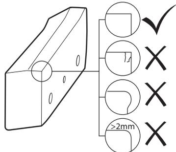
**ATENÇÃO!** Cortadores danificados podem causar danos à ferramenta. Nunca utilize cortadores quebrados ou danificados
