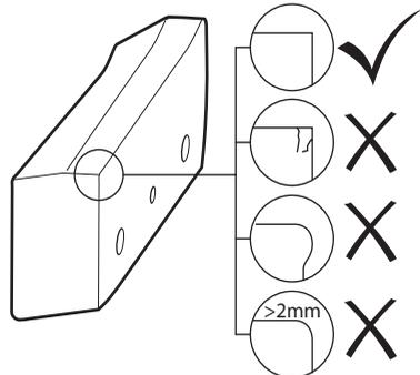
**UPOZORNĚNÍ!** Poškozené nůžky mohou nástroj poškodit. Řezací zuby nepoužívejte, pokud jsou prasklé nebo poškozené.
