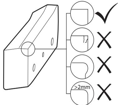
**POZOR!** Poškodené nožnice môžu spôsobiť poškodenie nástroja. Nikdy nepoužívajte prasknuté alebo poškodené rezacie zuby.
