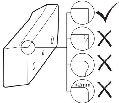
**注意!** シアラーが損傷すると、ツールの損傷を引き起こすことがあります。ひび割れや損傷のあるカッターは決して使用しないでください。
