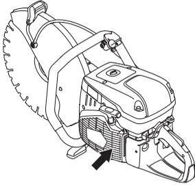
**NAPOMENA!** Priljav ili začepljen dovod vazduha dovodi do pregrevanja mašine, a samim tim do oštećenja klipa i cilindra.
