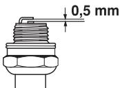
**NAPOMENA!** Uvek upotrebljavaj preporučeni tip svećice! Pogrešna svećica može da dovede do teškog oštećenja klipa/cilindra.
