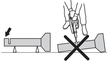
Ako se ne spreči opuštanje cevi i zatvaranje reza, sečivo će biti uštinuto u zoni povratnog trzaja i može doći do jakog povratnog trzaja. Ako je cev pravilno pričvršćena, njen kraj će se pomerati naniže, što znači da će rez otvarati, pa sečivo neće biti uštinuto.
