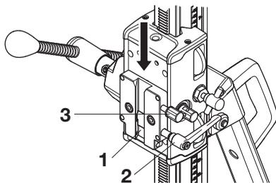
Ylempi lukitusruuvi (3) on tarkoitettu käytettäväksi vain yhdessä DMS 240.
