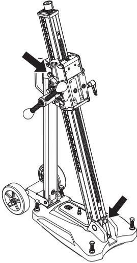
Løsn låseskruerne til søjlevipning og indstil den ønskede borevinkel. Fastspænd låseskruerne. Brug fremføringsgrebet. Søjlen kan vippes 0-60°.
