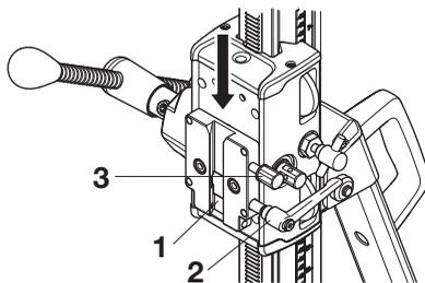
Använd den övre låsskruven (3) endast tillsammans med DMS 240.
