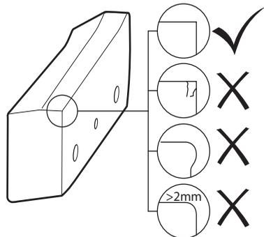
**NOTA!** Cesioie danneggiate possono causare danni allo strumento. Non usare mai dei taglienti spezzati o danneggiati.
