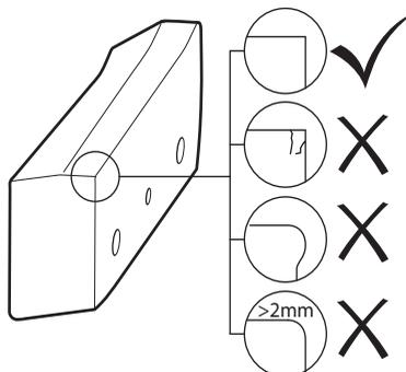
**AVISO** Unas cizallas dañadas pueden provocar daños en la herramienta. No utilice las cuchillas si están agrietadas o dañadas.
