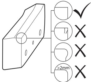
**BEMÆRK!** Beskadede sakse kan ødelægge værktøjet. Brug aldrig sprækkede eller beskadede skær.
