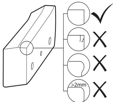
**HINWEIS!** Eine defekte Schere kann das Werkzeug beschädigen. Arbeiten Sie niemals mit einem gesprungenen oder beschädigten Schneidwerkzeug.
