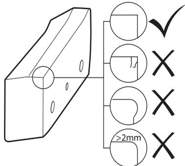
**MERKNAD!** En skadd saks kan skade verktøyet. Bruk aldri skjæregger som er sprukne eller skadet.
