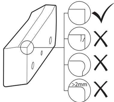
**OBS!** Skadade skär kan orsaka skada på verktyget. Använd aldrig spruckna eller skadade skär.
