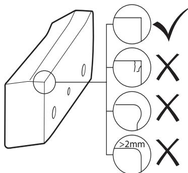
**ATTENTION !** Des cisailleurs endommagés peuvent endommager l'outil. Ne jamais utiliser de fraises fissurées ou endommagées.
