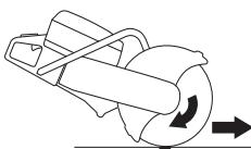
No traslade la máquina cuando el equipo de corte gira. Las fuerzas giroscópicas pueden obstaculizar el movimiento deseado.
