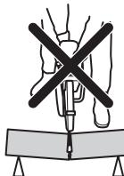
Si el disco se atasca o se engancha en el sector de riesgo de reculada, la fuerza reactiva empujará la cortadora hacia arriba y hacia atrás en dirección al usuario con un movimiento giratorio, lo que podría provocar daños graves o mortales. Preste atención al posible movimiento de la pieza de trabajo.
