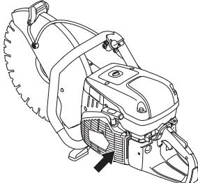
**ATTENTION !** Une prise d'air sale ou bouchée provoque la surchauffe de la machine, ce qui endommage le piston et le cylindre.
