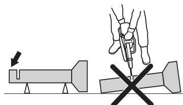
Si la tubería se hunde y se obstaculiza el corte, el disco se atascará en la zona de riesgo de sacudidas y podría producirse una sacudida muy violenta. Si la tubería está sujetada correctamente, el extremo de la tubería se moverá hacia abajo, se abrirá la zona cortada y no se producirá ningún atasco.
