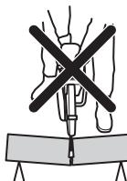
Si la lame se pince ou se coince dans la zone de rebond, la force de réaction va pousser la découpeuse vers le haut, puis la faire retomber en direction de l'utilisateur dans un mouvement de rotation qui peut causer des blessures sérieuses, voire mortelles. Faites attention aux éventuels mouvements de la pièce à travailler.
