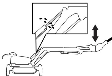
Цилиндр 3 выдвинут, молот работает вниз. Нельзя допускать работу машины, если цилинды находятся в крайних положениях.
