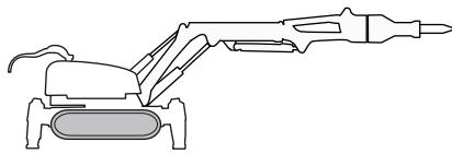
Каждая гусеница приводится во вращение с помощью отдельного гидромотора. Поворот машины осуществляется благодаря разным скоростям вращения гусениц. При вращении гусениц в разные стороны машина разворачивается на месте. Когда приводы гусеницы отключены, приводные двигатели блокируются пассивными тормозами.
