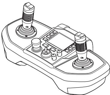
Машина управляется с пульта дистанционного управления. Сигналы поступают либо по беспроводной системе Bluetooth, либо по кабелю. Перемещение рычага управления имеет пропорциональный характер. Небольшое перемещение означает, что механизм будет перемещаться медленно, а большее перемещение вызовет перемещение механизма с большей скоростью.
