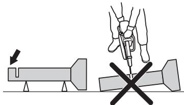
Se si permette che il tubo si incurvi e blocchi il taglio, la lama verrà schiacciata nel settore di contraccolpo causando un potenziale contraccolpo di grave entità. Se il tubo viene supportato adeguatamente, una sua estremità si sposterà verso il basso, il taglio si aprirà e non avverrà alcuno schiacciamento.
