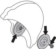
Utilizzare esclusivamente rondelle flangiate fornite da Husqvarna, diametro min. 105 mm/4,1'.
