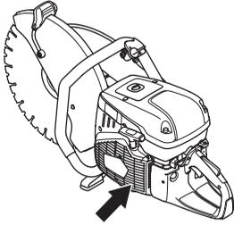
**NOTA!** Una presa d'aria di raffreddamento sporca od ostruita provoca il surriscaldamento della macchina, con conseguenti danni a cilindro e pistone.
