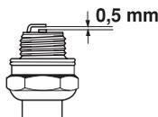
注記! 必ず指定のタイプのスパークプラグを使用してください! 不適切なスパークプラグを使用すると、ピストンやシリンダーが破損する原因となります。
