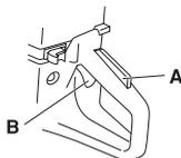
スロットルが押されている間は、トリガーロックは押されたままの状態を保ちます。ハンドルのグリップを放すと、スロットルトリガーとスロットルトリガーロックの両方が元の位置に戻ります。この動作は、2つの独立したリターンシステムが制御しています。この構造はつまり、スロットルトリガーが自動的にアイドリング状態でロックされることを意味します。
