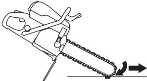
カッティング装置を回転させたまま、本機を移動しないでください。ジャイロ力により、意図した動きが阻害される場合があります。
