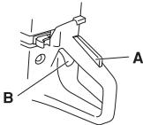
只要油门被按下，扳机锁就会保持按下。松开把手，油门扳机和扳机锁将都返回到原来的位置。这是通过两个独立的复位弹簧系统进行控制。这意味着油门扳机自动地锁定在怠速位置。
