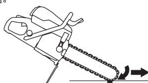
切割设备旋转时请勿移动本机。回转力会阻碍预期的移动。
