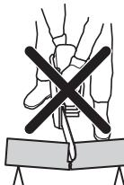
如果链条在反冲区被夹住或者受阻，反作用力会将电动切割锯向上向后抛起，飞向使用者，造成严重甚至致命性伤害。要警惕工件可能的移动。注意工件的移动或任何其它情形，以免造成切口闭合并夹住切割设备。
