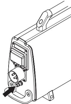
A outra ligação da água deve ser ligada à ferramenta eléctrica, a qual possui várias torneiras reguladoras para controlar o fluxo da água de arrefecimento. Consulte o manual do utilizador da ferramenta eléctrica em questão.
