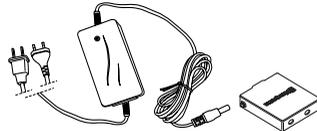
El tiempo de carga para una batería agotada es de aproximadamente 2-3 horas. El diodo se enciende de color naranja cuando la carga empieza y pasa a color verde cuando la batería se ha cargado por completo. Cuando la batería se ha cargado por completo, el cargador suministra a la batería corriente de mantenimiento hasta que se extraiga del cargador.
