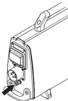
Στην άλλη σύνδεση νερού συνδέστε το ηλεκτρικό εργαλείο. Το ηλεκτρικό εργαλείο διαθέτει βάνες για τη ρύθμιση της ροής του νερού ψύξης προς το εργαλείο. Ανατρέξτε στο εγχειρίδιο χρήσης του αντίστοιχου ηλεκτρικού εργαλείου.
