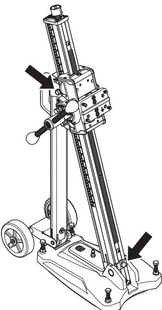
Draai de borgschroeven voor de kolomschuinstelling los en stel de gewenste boorhoek in. Draai de borgschroeven vast. Gebruik de toevoerhandgreep. De kolom kan in een hoek van 0-60° worden gezet.
