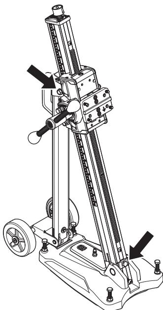
Χαλαρώστε τις βίδες ασφάλισης για την κλίση της στήλης και ορίστε τη γωνία διάτρησης που θέλετε. Σφίξτε τις βίδες ασφάλισης. Χρειασμοποιήστε το χειρολαβή τροψοδοσίας. Η στήλη μπορεί να πάρει κλίση 0-60°.
