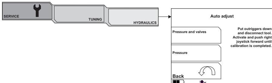
对于自动调整，机器须立在悬臂支架上，且工具须断开连接。选择校准“pressure and valves（压力和阀门）”或仅“pressure（压力）”。阀门校准将提高对机器移动的控制。压力校准将提高液压水平的精度。
