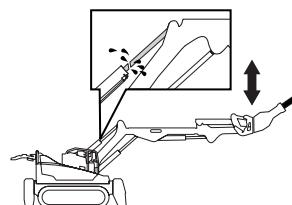
油缸 3 位于外侧位置，而液压锤工作方向向下。切勿将油缸置于其端部位置。
