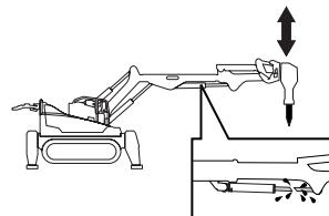
油缸 1 和 2 位于外侧位置，而液压锤工作方向向上。切勿将油缸置于其端部位置。
