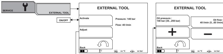
La machine peut être utilisée comme alimentation électrique pour faire fonctionner des outils hydrauliques externes. Les valeurs de pression et de débit d'huile peuvent être réglées du port A au port B. Sélectionnez le réglage que vous souhaitez modifier avec les touches de sélection. Utilisez les flèches pour modifier la valeur.
