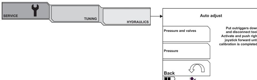
Pour le réglage automatique, la machine doit être posée sur les stabilisateurs et l'outil doit être déconnecté.
