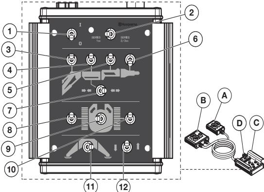
Сервисный контроллер используется только для транспортировки машины к месту обслуживания.
