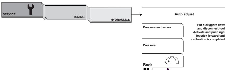
Для выполнения автоматической регулировки машина должна опираться на опоры, а инструмент должен быть отсоединен.
