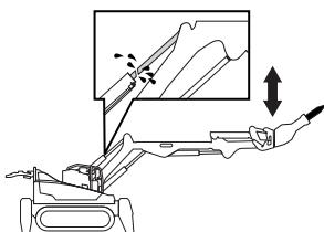
Цилиндр 3 выдвинут, молот работает вниз. Нельзя допускать работу машины, если цилиндры находятся в крайних положениях.
