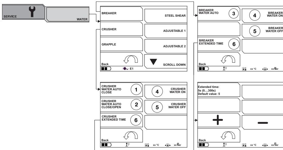
配备除尘套件的 DXR 能够使用喷水功能。该功能可以和各种工具一起配套启用。
