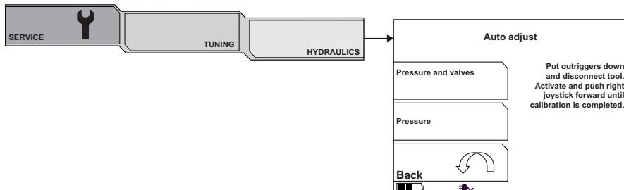
对于自动调整，机器须立在悬臂支架上，且工具须断开连接。
