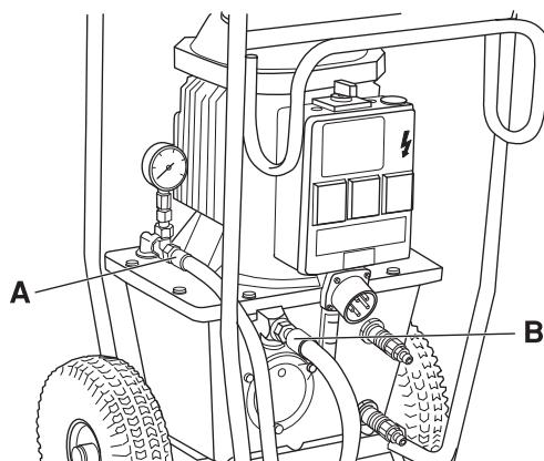
Manguera hidráulica, entrada de retorno (B)
