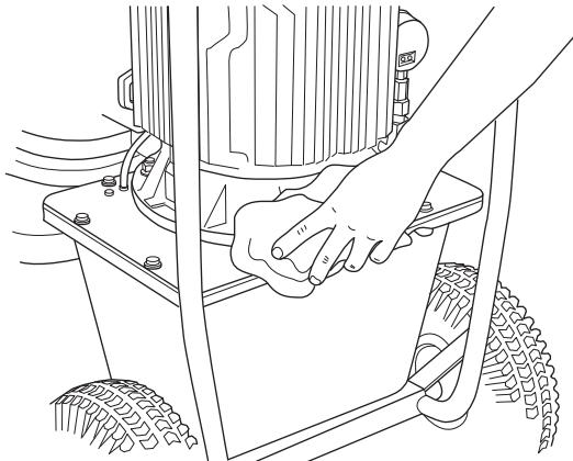
**REMARQUE!** Ne pas utiliser de nettoyeur haute pression pour le nettoyage du groupe moteur. Ne lavez pas la machine avec de l'eau. Elle peut en effet s'infiltrer dans le système électrique ou le moteur et ainsi endommager la machine ou provoquer un court-circuit.
