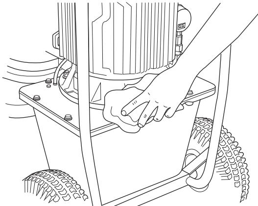
**¡NOTA!** No utilice un equipo de limpieza a alta presión para limpiar la unidad. No lave la máquina con agua, ya que puede penetrar en el sistema eléctrico o en el motor y causar daños en la máquina o un cortocircuito.
