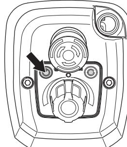
**Opomba! To velja za vrtalnike, ki so opremljeni z zemljostičnim stikalom.** Če se zemljostično stikalo sproži, ga morate resetirati.
