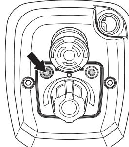
**Pozor! Ovo je primjenjivo na uređaje opremljene osiguračem uzemljenja.** Ako se osigurač uzemljenja na stroju uključi, tek tad ga možete resetirati.
