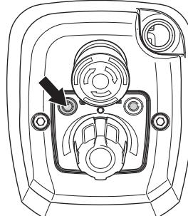
**Megjegyzés Ez a hibaáram-védőkapcsolóval rendelkező fúrógépekre vonatkozik.** Ha működésbe lépett a gép hibaáram-védőkapcsolója, akkor most visszaállítható.
