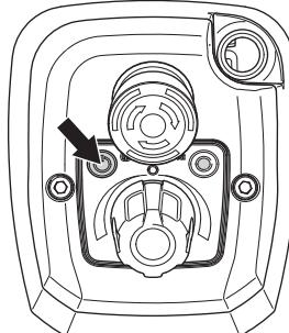
**Pamatujte si! To platí pro vrtačky vybavené zemním jističem.** Pokud je zemní jistič na stroji aktivován, v tomto okamžiku je možné ho resetovat.
