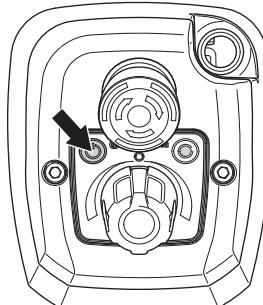
**Poznámka! Platí to pre vŕtacie stroje vybavené ističom uzemňovacieho okruhu.** Ak je zapnutý istič uzemňovacieho okruhu stroja, môže sa resetovať.
