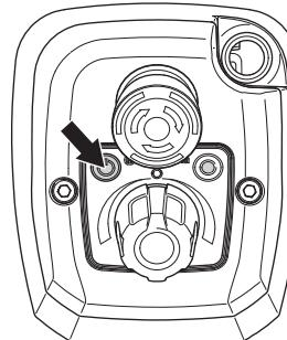
**Zauważ! Dotyczy wiertnic wyposażonych w wyłącznik różnicowo-prądowy.** Jeżeli wyłącznik różnicowo-prądowy obwodu jest uruchomiony, w tym punkcie może on zostać zresetowany.
