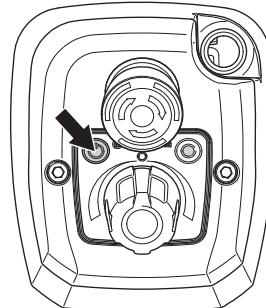
**Notera! Gäller borrmaskiner utrustade med jordfelsbrytare.** Om jordfelsbrytaren på maskinen löst ut är det först i detta läge som jordfelsbrytaren går att återställa.
