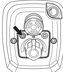
**Bemærk! Dette gælder for boremaskiner, der er udstyret med jordfejlafbryder.** Hvis maskinens jordfejlafbryder er udløst, kan jordfejlafbryderen nulstilles på dette tidspunkt.
