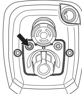
**Bemerk! Dette gjelder bormaskiner som er utstyrt med jordfeilbryter.** Hvis jordfeilbryteren på maskinen utløses, kan jordfeilbryteren tilbakestilles på dette punktet.
