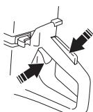
**CHÚ Ý!** Kéo từ từ dây khởi động bằng tay phải cho đến khi bạn cảm nhận được lực cản (khi vấu dây khởi động được gài vào), sau đó kéo chắc và nhanh.
