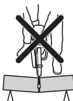
ブレードがキックバックゾーンで挟まったり、引っかかったりすると、反作用力により、作業者に向かってパワーカッターが回転しながら飛ばされて、人命にかかるような事故が発生することもあります。作業対象物が動く可能性があるので、注意してください。作業対象物がしっかりと保持されておらず、切断時に動くと、ブレードが挟まり、キックバックの原因になる可能性があります。
