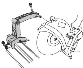
**HUOMAUTUS!** Kiskopidike on kiinnitettävä kiskoona ennen laikkaleikkurin kiinnittämistä kiskopidikkeeseen. Tällä taataan, että pidike kiinnitetään kiskoona oikeista kulmista.
