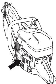
**MERKNAD!** Et tilsmusset eller blokkert luftinntak fører til at maskinen blir overopphevet, noe som forårsaker skade på stempel og sylinder.
