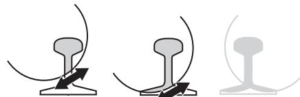
Dacă tăietura nu poate fi finalizată de pe o latură, freza electrică trebuie răscută.
