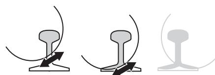
Kesme işlemi tek bir taraftan tamamlanamıyorsa, motorlu testere ters yöne döndürülmelidir.
