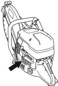
**ИЗВЕСТИЕ!** Замърсен или блокиран смукателен въздухопровод предизвиква прегряване на машината, което води до повреждане на буталото и цилиндъра.
