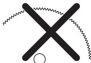
Використання цього бензоріза з дисками з твердосплавними пластинами є порушенням правил техніки безпеки.
