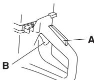
Dispozitivul de blocare rămâne apăsat atât timp cât este apăsată supapa de admisie. Când maneta este eliberată, atât accelerarea, cât și blocatorul accelerării revin la pozițiile lor inițiale. Acest lucru se obține cu ajutorul a două sisteme cu resorturi de revenire, independente unul față de celălalt. Această poziție implică blocarea automată a accelerării în poziția de mers în gol.
