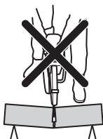
Якщо різець є затиснутим або закліненим у зоні віддачі, реактивна сила штовхне бензоріз в обертовому русі наверх та назад, вбік користувача, що може привести до тяжких і навіть смертельних травм. Урахуйте можливе зсування оброблюваного предмета. Якщо оброблюваний предмет не закріплено належним чином і зміщується під час різання, він може затиснути лезо та спричинити віддачу.
