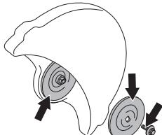
Рекомендується використовувати шайби фланця виробництва фірми Husqvarna з мінімальним діаметром 105 мм/4,1 дюйма.
