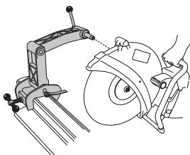
**УВАГА!** Спочатку необхідно закріпити затискач на рейці, а потім кріпiti ручний різальнік до затискача. Це робиться для гарантії фіксації пристрою під правильним кутом до рейки.
