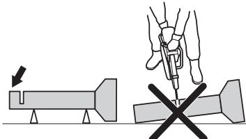
Ако тръбата провисне и затвори прореза, режещият диск ще бъде защищен в зоната на откат и е възможно да възникне силен откат. Ако тръбата е добре застопорена, краят на тръбата ще се двинжи надолу, прорезът ще се разтваря и няма да се получи зашиване.
