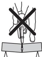
Dacă lama este prinsă sau blocată în zona de recul, forța de reacție va împinge motofierastrăul în sus și înapoi spre operator, într-o mișcare de rotație, cauzând vătămări corporale grave sau chiar mortale. Fiți atenți la o potențială mișcare a piesei de lucru. Dacă piesa de lucru nu este corect susținută și se mișcă în timpul tăierii, aceasta poate intra în contact cu lama și poate cauza recul.
