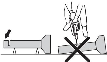
Dacă conducta se poate încovoa și închide tăietura, va exista un contact cu lama în zona de recul, ceea ce poate produce un recul important. Când conducta este corect susținută, capătul acesteia se va deplasa în jos, tăietura se va deschide și nu va exista contact.
