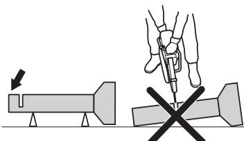
Якщо буде можливим прогинання труби із закриванням розрізу, лезо буде затиснути в зоні віддачі, що може спричинити дуже сильну віддачу. Якщо труба правильно покладена на опору, кінець труби відхиляється донизу, розріз розшириться і лезо не буде затиснute.
