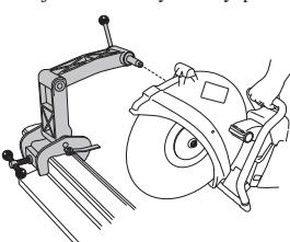
**NOT!** Motorlu testere ray tırtılısına takılmadan önce ray tırtılısı raya takılmalıdır. Bunun amacı tırtılınin raya dik açılar ile tutturulmasının sağlanmasıdır.
