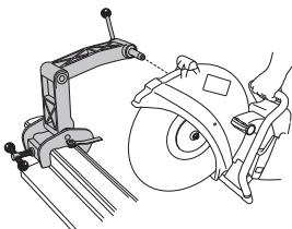
**AVERTISMENT!** Armătura şinei trebuie să fie montată mai întâi pe şină înainte ca motofierastrăul să fie montat pe armătura şinei. Această operațiune este efectuată pentru a vă asigura că armătura este montată la unghiul corect pe şină.
