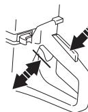
Porniți freza electrică și deschideți complet supapa de admisie. Eliberați dispozitivul de control al supapei de admisie și asigurați-vă că lama de tăiere se oprește și rămâne staționară. Dacă lama de tăiere se rotește când supapa de admisie este în poziție de repaus, trebuie să verificați reglajul de repaus al carburatorului. Consultați instrucțiunile din capitolul „Întreținerea”.
