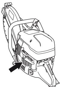
**NOT!** Hava girişinin kirli veya tıkanmış olması, makinenin aşırı ısınmasını ve pistonun ve silindirin zarar görmesine neden olabilir.
