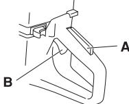
Gaz basıldı olduğu sürece, tetikleme kilidi basılı kalır. Tutma yeri üzerindeki tutacak açıldığında, gaz tetiği ve gaz tetiği kilidi eski konumuna döner. Bu, iki bağımsız geri tepme yayı ile sağlanır. Bu sayede, gaz tetiği rölati ayarında otomatik olarak kilitlenir.
