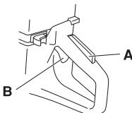
Цей запобіжник застосується натиснутим весь час, коли натиснутий важіль дроселя. Якщо відпустити рукю'я, важіль дроселя та запобіжник важеля дроселя повертаються до своїх вихідних положень. Пересування здійснюється за допомогою двох незалежних зворотних пружинних механізмів. Це означає, що важіль дроселя автоматично фіксується у позиції холостого ходу.
