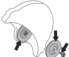
Utilizați numai șaibe de flanșe furnizate de Husqvarna, cu diametrul minim de 105 mm / 4,1'.
