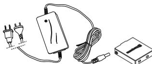
O tempo de carregamento de uma bateria descarregada é de aproximadamente 2-3 horas. O diodo encontra-se cor-de-laranja quando o carregamento é iniciado e fica verde quando a bateria está totalmente carregada. Quando a bateria está totalmente carregada, o carregador fornece corrente de manutenção à bateria até esta ser removida do carregador.
