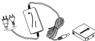
El tiempo de carga para una batería agotada es de aproximadamente 2-3 horas. El diodo se enciende de color naranja cuando la carga empieza y pasa a color verde cuando la batería se ha cargado por completo. Cuando la batería se ha cargado por completo, el cargador suministra a la batería corriente de mantenimiento hasta que se extraiga del cargador.
