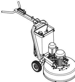
As máquinas de alisamento de pisos Husqvarna PG 680/820 foram concebidas para a rectificação húmida ou seca de mármore, terrazzo, granito e cimento. As suas aplicações vão desde o desbaste até um acabamento polido. A máquina destina-se a utilização comercial, por exemplo em hotéis, escolas, hospitais, fábricas, escritórios, etc.
