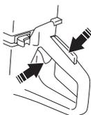
**注意！**用右手将启动器拉绳缓慢拉出，直至感觉到阻力（由于启动器棘爪啮合），然后用力快速拉动。
