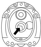
8 Aseta uusi O-renkas moottorikotelon ja vaihdelaatikkokotelon väliin. Ota yhteys jälleenmyyjään oikean O-renkaan saamiseksi.
