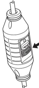
Fejlstrømsafbryderen bør slå fra, og maskinen skal slukke øjeblikkeligt. Hvis det ikke er tilfældet, skal du kontakte forhandleren.
