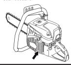
AVISO Una toma de aire sucia u obturada produce el sobrecalentamiento de la máquina, con las consiguientes averías del cilindro y el pistón.
