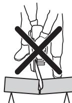
If the chain is pinched or stalled in the kickback zone, the reactive force will push the power cutter up and back towards the user in a rotating motion causing serious or even fatal injury. Legyen elővigyázatos, ha a munkadarab meghozzuk. Legyen elővigyázatos, ha a munkadarab meghozzuk, vagy bármilyen más rögzítésben van, aminek következtében a vágási rés szükségesen válthat, és a vágószerkezet beszorulhat.
