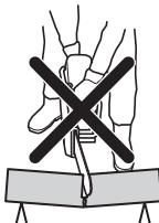
Jeżeli łańcuch zaklinuje się w strefie odbicia, siła reakcji może obrócić przecinarkę do góry i do tyłu w stronę użytkownika, powodując poważne lub nawet śmiertelne obrażenia. Uważnie obserwuj potencjalne ruchy ciętego materiału. Bądź czujny na przesunięcie materiału ciętego lub na inne okoliczności, które mogłyby spowodować zamknięcie szczeliny i zakleszczenie osprzętu tnącego.
