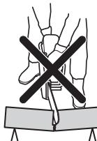
Pokud se řetěz skřípne nebo zasekne v zóně zpětného vrhu, vyhodí zpětná síla roztočenou rozbrušovací pilu směrem nahoru a zpátky na obsluhu, čímž může způsobit vážné či dokonce smrtelné úrazy. Mějte se na pozoru před možným pohybem zpracovávaného dílu. Dávejte pozor na pohyb opracovávaného objektu a na jiné okolnosti, které mohou způsobit sevření řezu a skřípnutí řezacího příslušenství.
