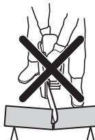
Ak sa reťaz zasekla alebo uviazla v zóne spätného nárazu, reakčná sila rotačným pohybom vyhodí rozbrusovaciu pílu nahor a dozadu smerom na používateľa a môže spôsobiť vážne alebo dokonca smrteľné zranenie. Dávajte pozor na potenciálny pohyb obrobku. Dávajte pozor na pohyb obrobku alebo na čokoľvek, kvôli čomu by sa mohol rez zatvoriť a zaseknúť rezné zariadenie.
