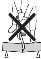
如果链条在反冲区被夹住或者受阻，反作用力会将电动切割锯向上向后抛起，飞向使用者，造成严重甚至致命性伤害。要警惕工件可能的移动。注意工件的移动或任何其它情形，以免造成切口闭合并夹住切割设备。
