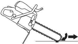
切割设备旋转时请勿移动本机。回转会阻碍预期的移动。
