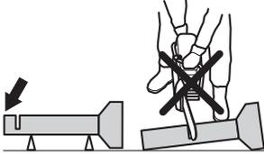
如果管道下垂并使切口闭合，导板在反冲区会被夹住，可能发展为严重的反冲。如果妥善支撑管道，管道的末端将向下移动，切口将保持张开，不会夹住锯片。
