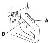
只要油门被按下，扳机锁就会保持按下。松开把手，油门扳机和扳机锁将都返回到原来的位置。这是通过两个独立的复位弹簧系统进行控制。这意味着油门扳机自动地锁定在怠速位置。
